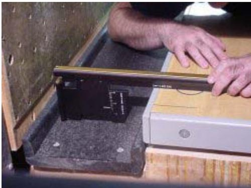
*Mesure de la profondeur du puits avec la jauge à dalot et à puits*
