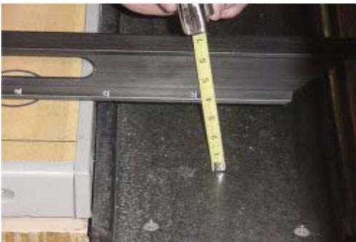
*Détermination de la partie la moins profonde du dalot avec un ruban à mesurer et un niveau*
