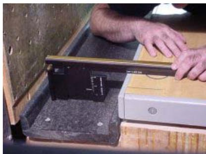
*Utilisation de la jauge de dalot et de puits pour la mesure de la profondeur du dalot*
