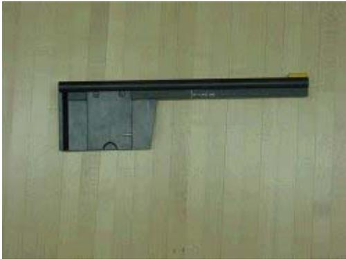
2. Le bout possède une petite glissière argent (ou or) qui est utilisée pour stabiliser la jauge lors de la mesure de la profondeur du puits.
