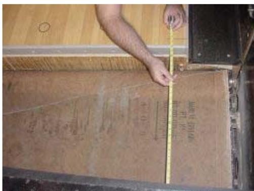
*Mesure de l'extrémité de l'allée jusqu'au coussin du puits avec le ruban à mesurer*
